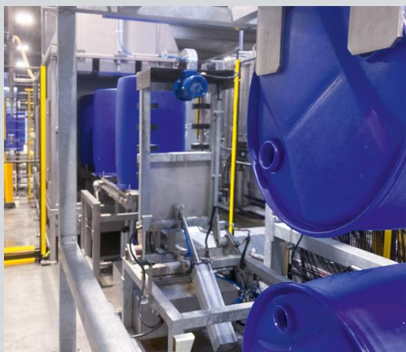
Lo specialista belga del ricondizionamento Remitack amplia le sue capacità con un nuovo impianto di lavaggio completamente automatico per fusti in plastica. L'impianto della controllata SCHÜTZ, entrato in funzione a fine ottobre, soddisfa i massimi requisiti tecnici e garantisce processi sostenibili nel ricondizionamento dei fusti. I clienti beneficiano tra l'altro di una maggiore riciclabilità e di una accresciuta disponibilità di fusti a tappo in plastica lavati.
