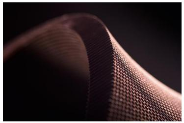
**Bildtext:** Das moderne Wabenmaterial CORMASTER® basiert auf Aramidpapier und kommt überall dort zum Einsatz, wo geringes Gewicht bei gleichzeitig höchster Stabilität gefordert ist.
