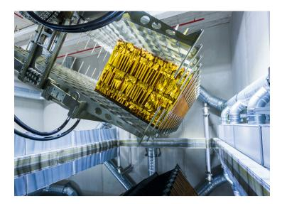
**Légende**: Cette nouvelle ligne de production permet la fabrication hautement automatisée de blocs en nid d'abeille d'une taille pouvant atteindre 2700 x 3600 mm
